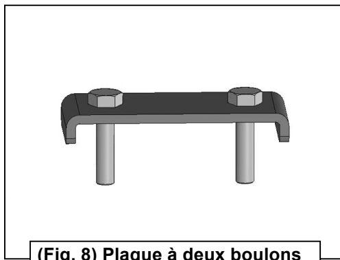
(Fig. 8) Plaque à deux boulons de 8 mm
