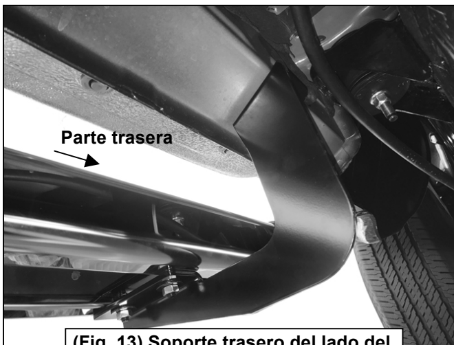
(Fig. 13) Soporte trasero del lado del pasajero sujetado al estribo lateral
